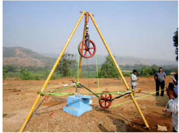
(ख) उखालू में ट्राई-पॉड सेटअप का प्रयोग करते हुए स्थापित किया जा रहा एक 4.5Hz, 3- घटक वेधछिद्र सोन्ड (1500 मी)
