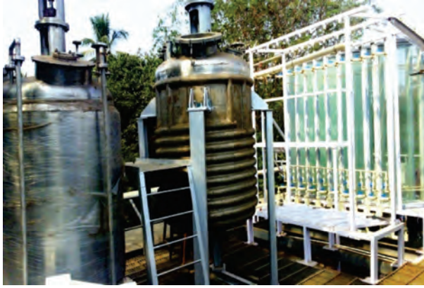
उल्वा कृषि के लिए डीवीटी-आईसीटी केन्द्र पर विकसित और अभिकल्पित 3000 लीटर फोटो बायो रियेक्टर प्रणाली
