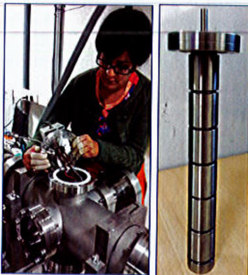
चित्र 7 बहु और परिवर्तनशील आकार के रंधों के साथ वायुगतिकीय लेंस
