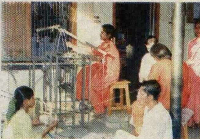
VIII.क.3. आर टी डी टी केन्द्र पर एक ग्रामीण युवा द्वारा निर्मित पटसन बुनाई मशीन संचालित
