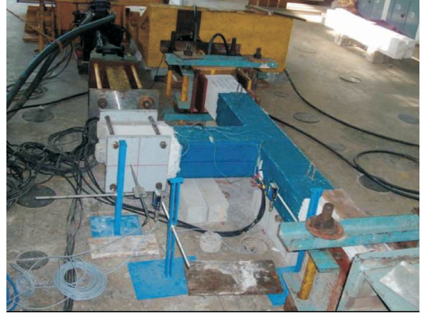
चित्र : बीम-कॉलम ज्वाइंट पर साइक्लिक टेस्ट हेतु टेस्ट सैट
