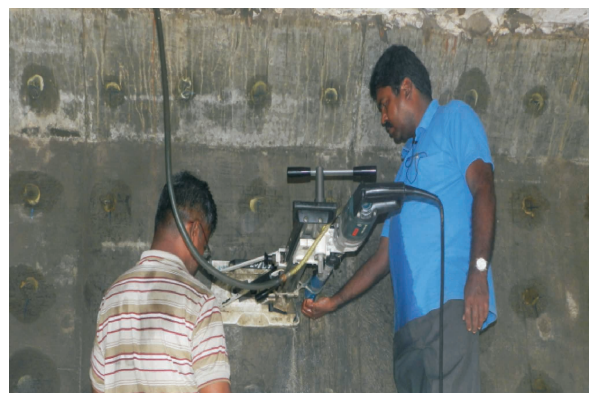
चित्र : ट्रिपेनिंग तकनीक का प्रयोग करते हुए रेजीडियूल प्रीस्ट्रेसिंग फोर्स का आकलन
