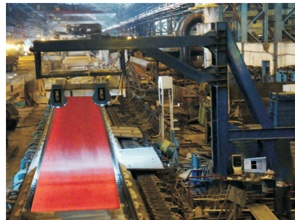
चित्र. हॉट रोल्ड स्टील स्ट्रिप्स हेतु ऑनलाइन सतह निरीक्षण मॉड्यूल
