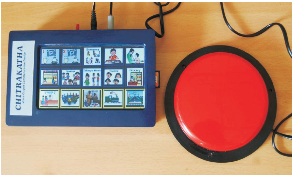
ईआर शामिल पात्रा, टीयूसी आईआईटी, खड़गपुर द्वारा बहु परत परीक्षणीय आवाज आउटपुट संचार सहायता और विशेष उपयोग स्विच
