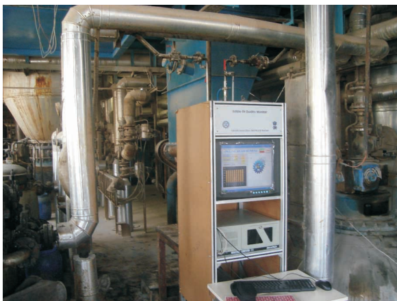
चित्र. खाद्य तेल उद्योग में गुणवत्ता मूल्यांकन हेतु एनआईआरएस पर आधारित ऑन-लाइन इंस्ट्रूमेंट
