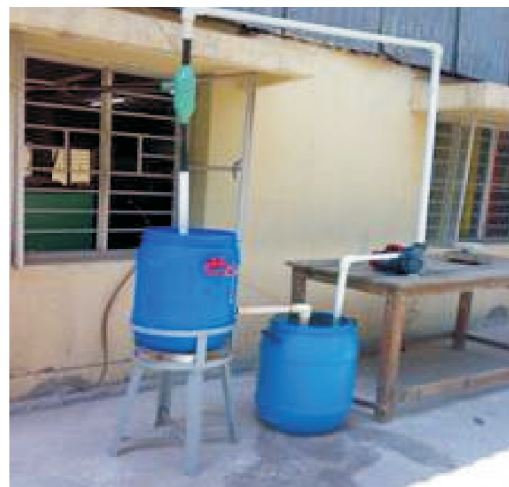
चित्र. सोडियम निष्कर्षण के दौरान क्लोरिन हैंडलिंग हेतु घरेलू प्रणाली
