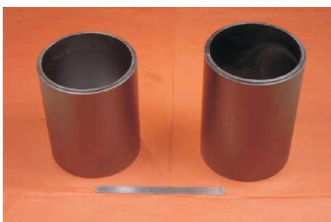
चित्र. PyC कोटिंग सहित आईजीसीएआर के ग्रेफाइट क्रूसिबल्स कोटिंग के चित्र
