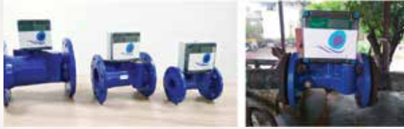
चित्र 11. परियोजना निधि की सहायता से विकसित किए गए अल्ट्रासोनिक पाइप प्रवाहमापी। फ्लोमीटर अब व्यावसायिक रूप से निर्मित हैं।
