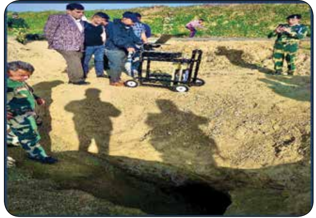
चित्र 1: भूमिगत उपयोगिताओं का पता लगाने, इमेजिंग और मानचित्रण के लिए रेडियो फ्रीक्वेंसी डिवाइस
