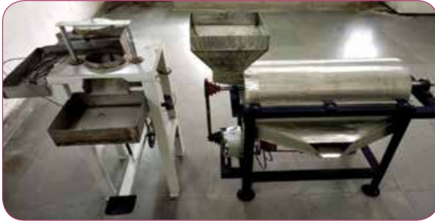
चित्र: 7 बेल फ्रूट पल्प एक्सट्रैक्टर उपकरण
